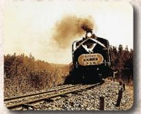
国鉄C11形蒸気機関車は、日本国有鉄道（国鉄）の前身である鉄道省が製造した過熱式のタンク式蒸気機関車です。Cのチヨンチヨンという愛称で呼ばれています。
